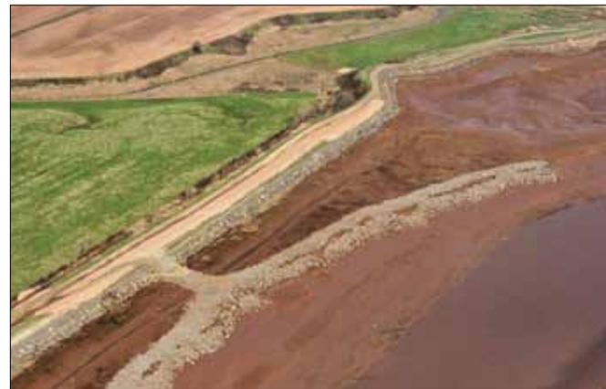
Figure 5-4 Brise-lames et parement de roches qui servent à atténuer l'impact des ondes de tempête sur les digues.
